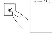
7. 再次按下時間設置按鍵，則螢幕切換至時間設置，此時，表示時間的第一位數位(表示小時)開始閃動。
